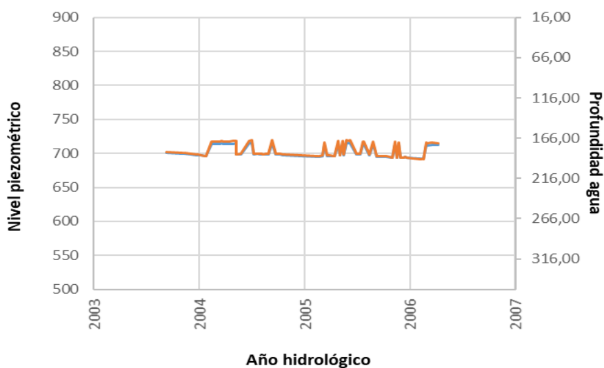
Figura 1. Evolución del nivel piezométrico y la profundidad del agua en el sondeo de Erque II (Ac. Insular ES70LG001).
