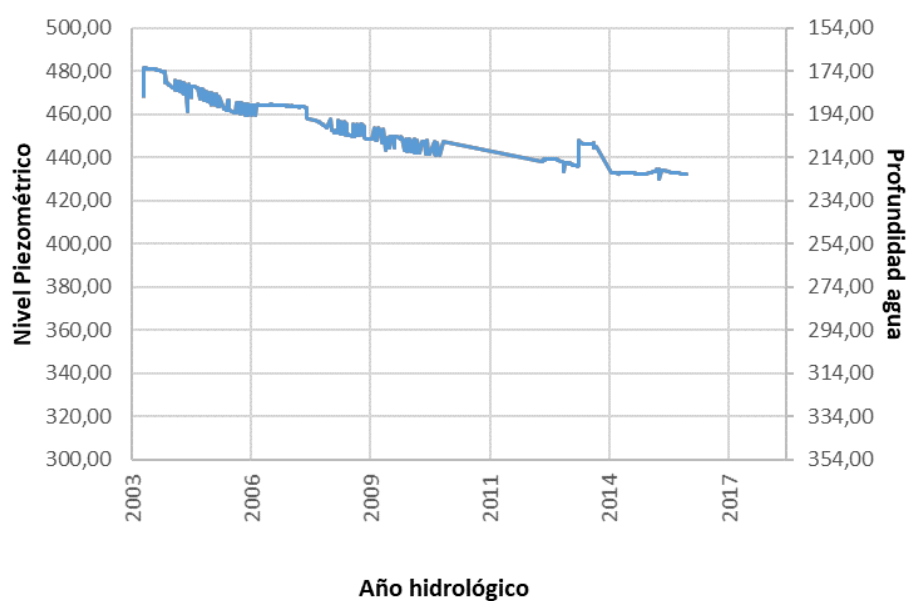
Figura 9. Evolución del nivel piezométrico y la profundidad del agua en el sondeo de Los Campos (Ac. Insular ES70LG001).
